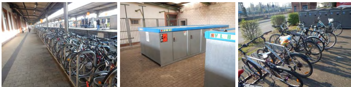
Figure 170 : Accès face ouest: arceaux couverts, boxes pour un vélo, emplacements avec fixation de la roue avant
